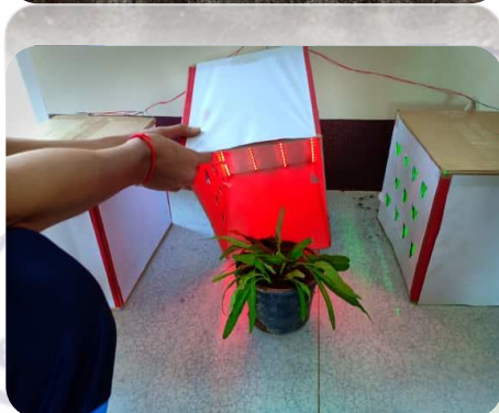
ภาพที่ ก-5 นำกล่องที่ติดหลอด LED เรียบร้อยแล้ว มาครอบกระถางปลูกผักที่ได้เตรียมไว้ทั้ง 3 กระถาง และอีก 1 กระถาง ให้รับแสงจากดวงอาทิตย์
