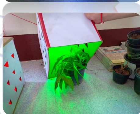
ภาพที่ ก-5 นำกล่องที่ติดหลอด LED เรียบร้อยแล้ว มาครอบกระถางปลูกผักที่ได้เตรียมไว้ทั้ง 3 กระถาง และอีก 1 กระถาง ให้รับแสงจากดวงอาทิตย์
